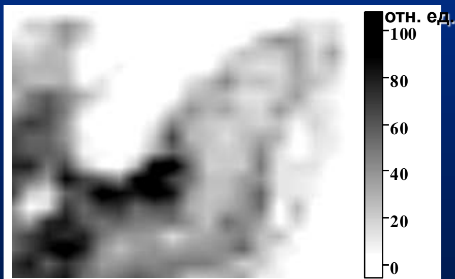
распределение октакарбокситалоцианина кобальта, измеренное на основе эффекта резонансного КР
