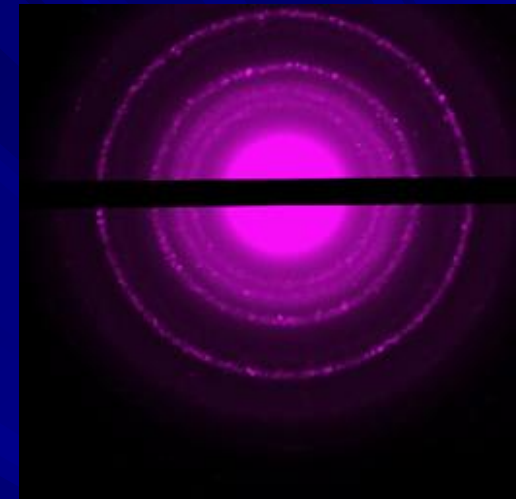
Электроннограмма исходного порошка наночастиц
